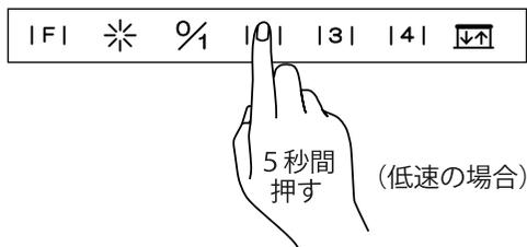
それぞれの風速スイッチに 5 秒以上触れてから離すとスイッチのバックライトが点滅し、5 分後にファンが停止し、リフトパネルが自動的に
