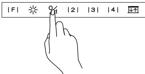
ファン"ON/OFF"スイッチに触れてから離すとスイッチのバックライトが点灯し、微速運転になります。
