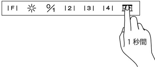
昇降スイッチに指先で（**1秒間**）触れてから離すと昇降スイッチのバックライトが点灯し、（**1秒後**）にリフトパネルがせり上がってきます。そして、上昇開始 8 秒後に自動的に微速運転に入ります。
