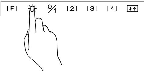
LED照明スイッチに触れるとLED照明が点灯、スイッチのバックライトも点灯します。
