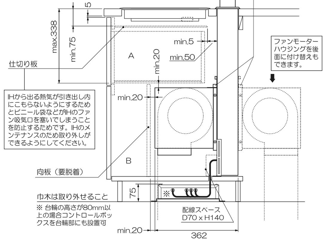
IHから出る熱気が引き出し内にももらないようにするためとビニール袋などがIHのファン吸気口を塞いでしまうことを防止するためです。IHのメンテナンスのため取り外しができるようにしてください。
